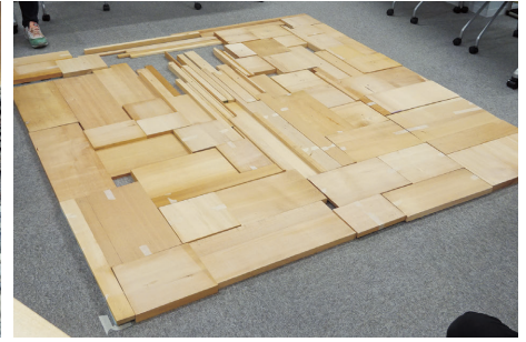
写真4 不定形部材(廃木材)の配置
