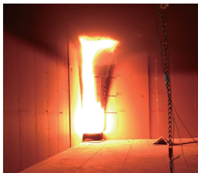
写真1 内装の延焼経路
