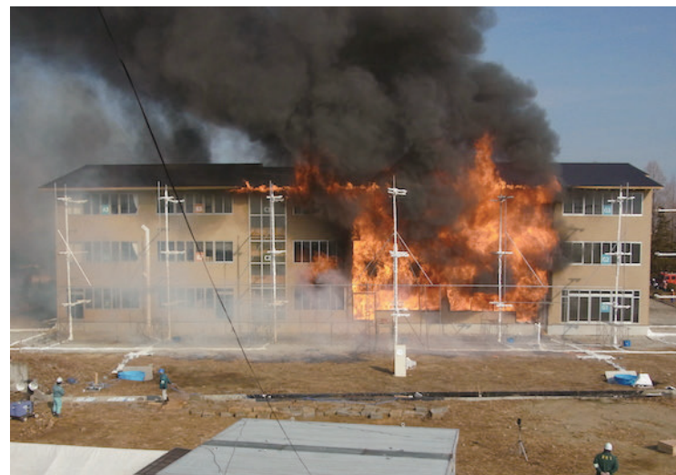
写真1 フラッシュオーバー後の火災最盛期の様子
