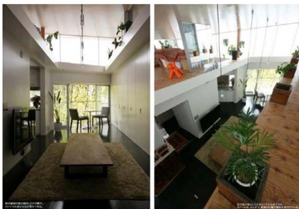
豪雪地の住宅。以前の家では、3mの積雪のため、冬季、1階窓を雪囲い板で覆い、自然光が遠かった。施主は1階主体の生活を希望し、解法として、小屋裏をロフトとし、積雪より高いロフト窓からの自然光が、床の開口部経由で1階に届くようにした。それが、家族の柔らかなつながりや、サスティナブルな家の運用も喚起した。
