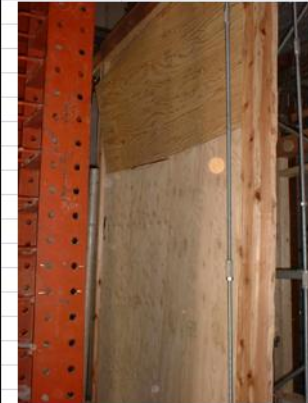
図1 合板真壁破壊状況 全景
