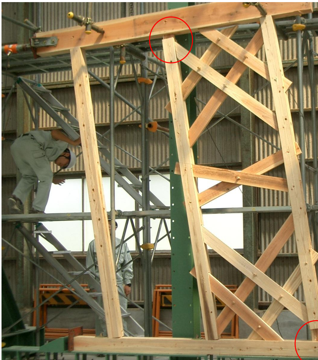
壁を強くしても柱脚柱頭接合部が弱いと柱が引き抜けて破壊する
