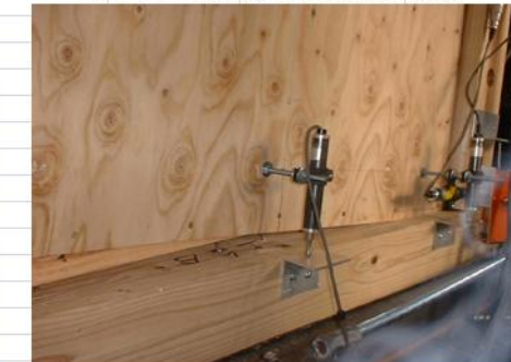
図4 合板真壁破壊状況
